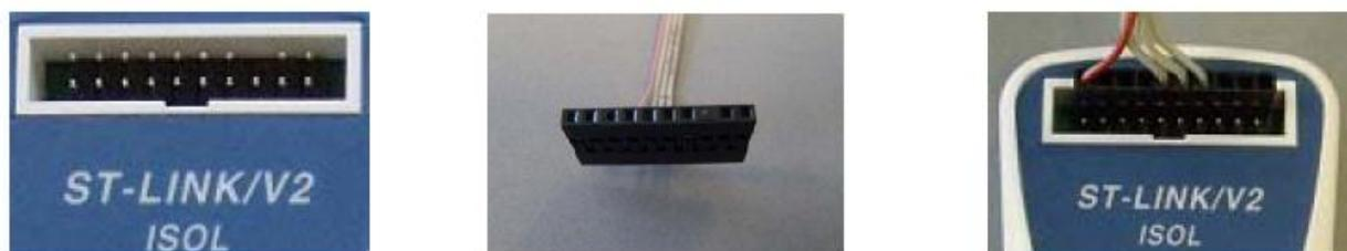
На рисунке 7 показано, как подключить ST-LINK/V2, если на плате приложения имеется 4-контактный SWIM-разъем с шагом 2,54мм.
