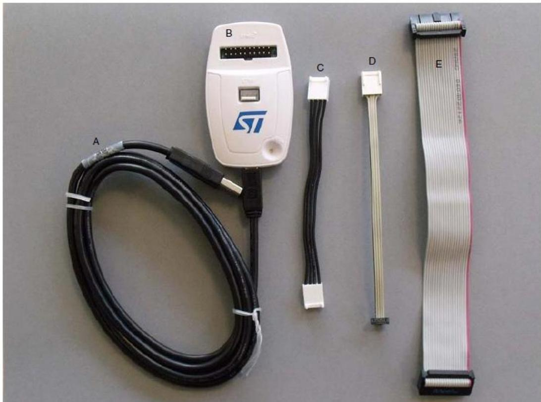
**Рисунок 3. Комплектация ST-LINK/V2-ISOL**
