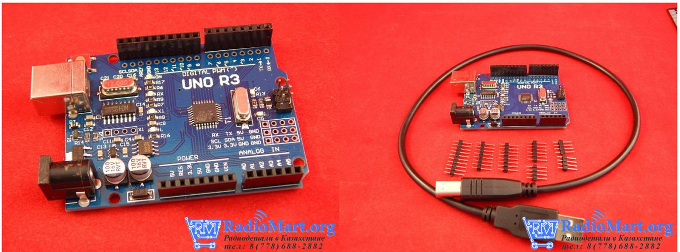
Arduino Uno в SMD исполнении. UNO - одна из наиболее популярнейших плат из серии Arduino. Такая плата подойдет для большинства проектов, которые вы пожелаете воплотить. Благодаря монтажным отверстиям, всю подключаемую периферию можно будет надежно запаять.
