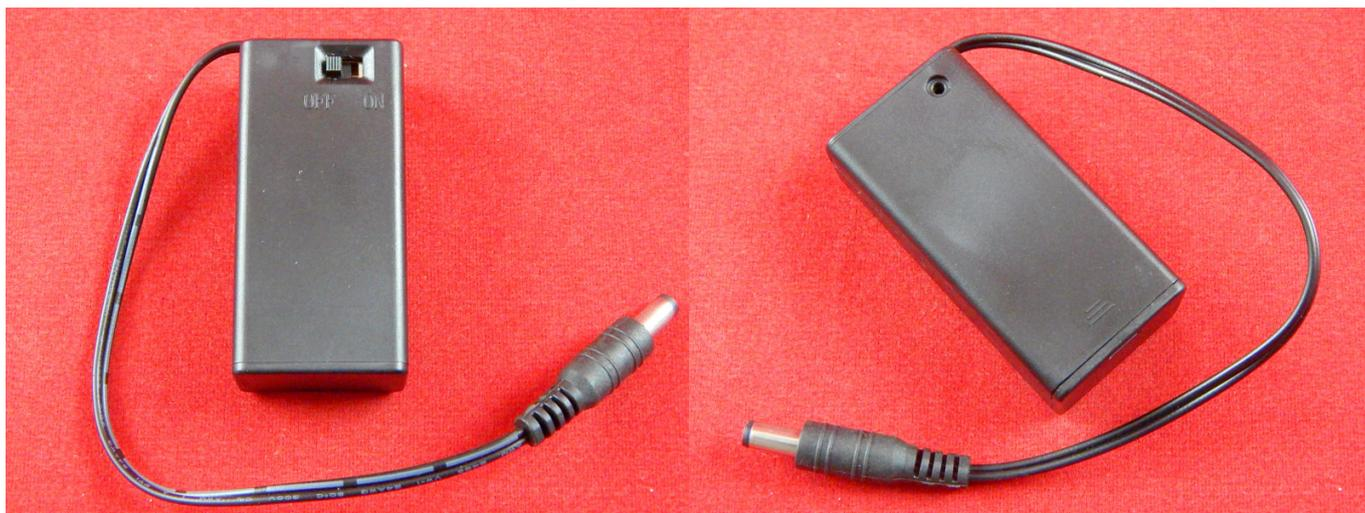
Батарейный отсек для 9В "Кроны" со штекером в корпусе с выключателем
