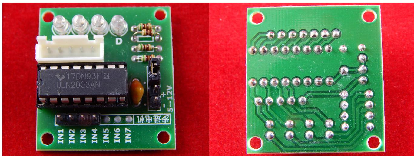
Плата управления шаговыми двигателя на микросхеме ULN2003.
