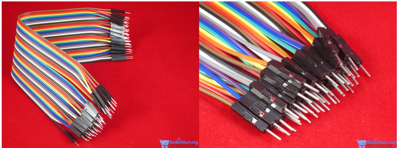
Соединительные провода папа-папа. Используются для удлинения, соединения на платах Arduino, либо как перемычка.
