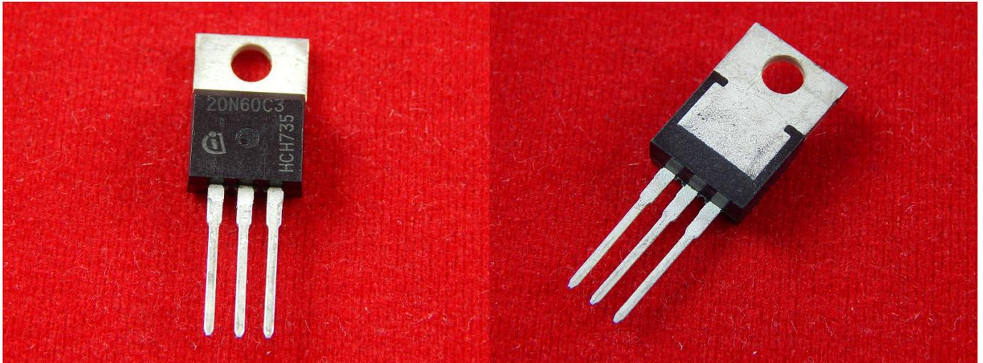
SPP20N60C3, Транзистор, N-канал 600В 20А 0.19Ом [TO-220AB]
