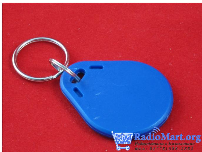
Брелок-заготовка Mifare является ключом в виде брелка для идентификации в системах СКД и домофонных системах. Представляет собой брелок в форме капли, изготовленный из ABS пластика, в который помещен чип Philips MF 1 S50 с антенной. Брелок является водонепроницаемым и устойчивым к ударам. Представлен в синем корпусе с белой вставкой.
