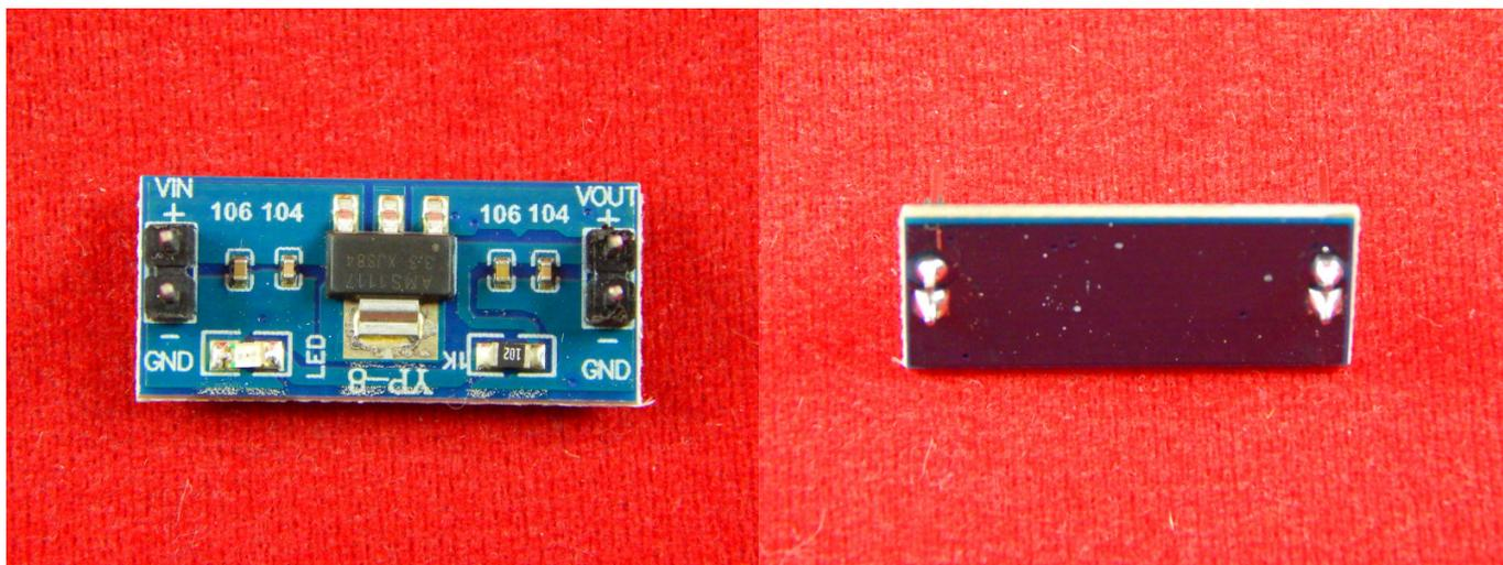
DC-DC стабилизатор напряжения, конвертирует входное: 5-12В в 3.3В. Работает на микросхеме AMS1117.
