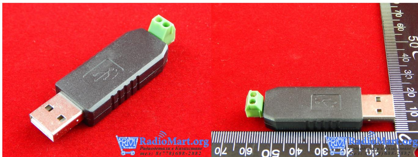
RS485 — симплексный интерфейс. Это означает, что в любой момент времени данные могут передаваться только одним узлом сети. Причём данные передаются сразу по двум проводам дифференциальным методом: передаваемый бит кодируется разностью потенциалов между двумя проводами линии.
