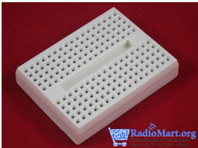
Эта макетная плата предназначена для быстрой сборки простых электронных схем. Позволяет обойтись без пайки, мгновенно изменять схему, подобрать наилучшую конфигурацию и номиналы деталей. Будет чрезвычайно полезна для проверки деталей бывших в работе, позволяет моментально собрать проверочную схему.
