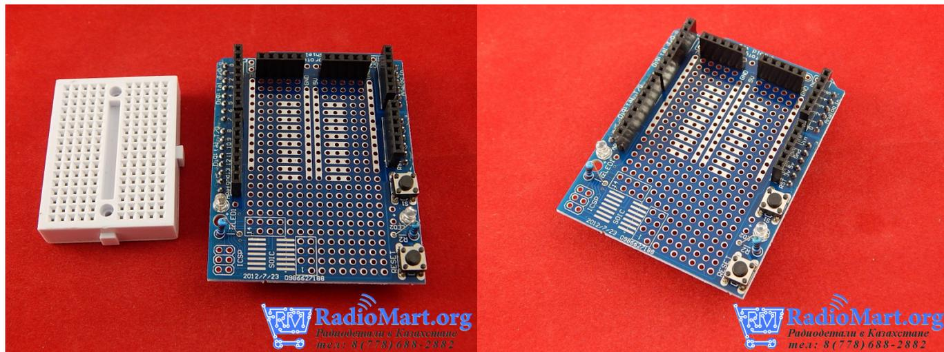
Монтажная плата для Arduino. В комплекте монтажная плата на 180 контактов
