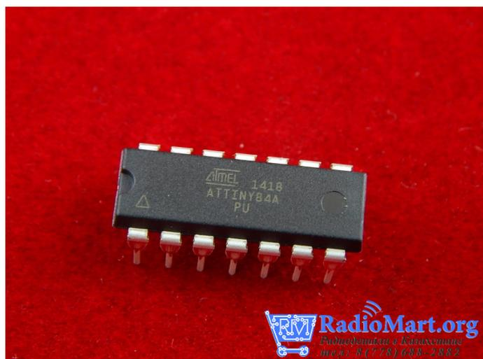
Микроконтроллер ATtiny84 принадлежит семейству микроконтроллеров AVR фирмы Atmel. ATtiny84 имеет 8кб Flash памяти и по 512кб SRAM и EEPROM памяти. ATtiny84 может работать на частоте до 20МГц с внешним кварцевым резонатором и до 8МГц с внутренним генератором.
