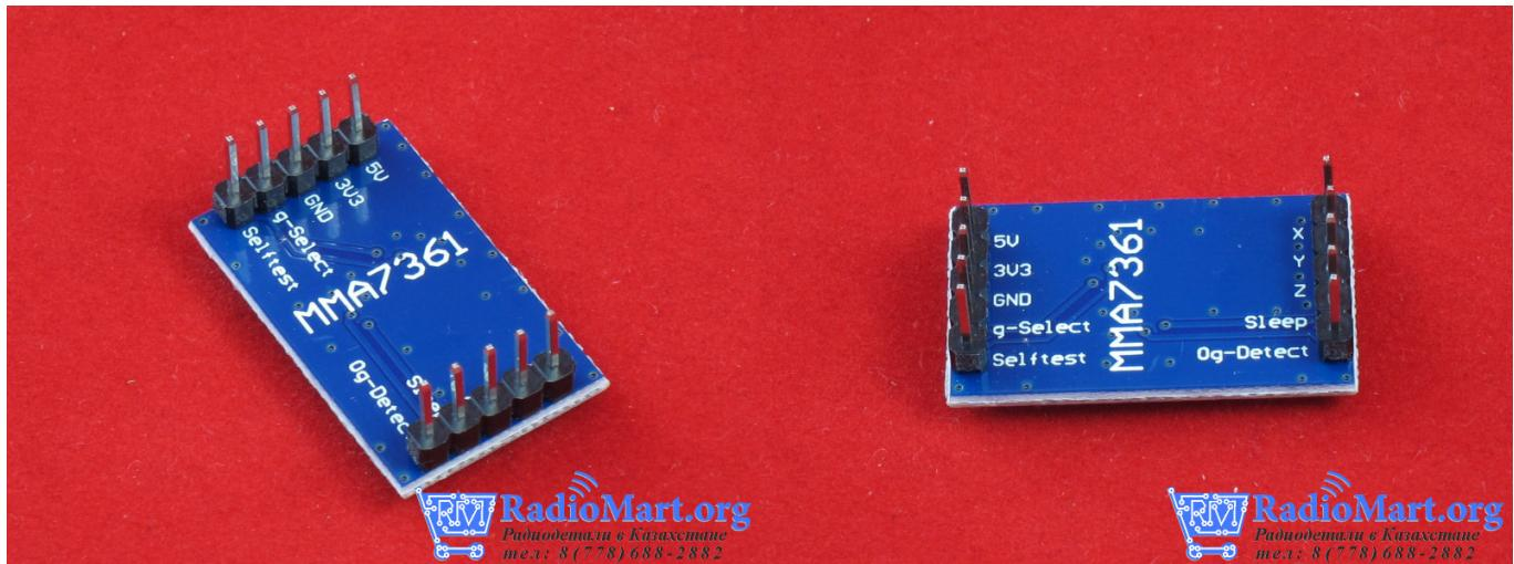
3-х осевой акселерометр (датчик положения или ускорения) MMA7361 предназначен для измерения ускорения предмета, которое оно приобретает при смещении относительно своего нулевого положения.
