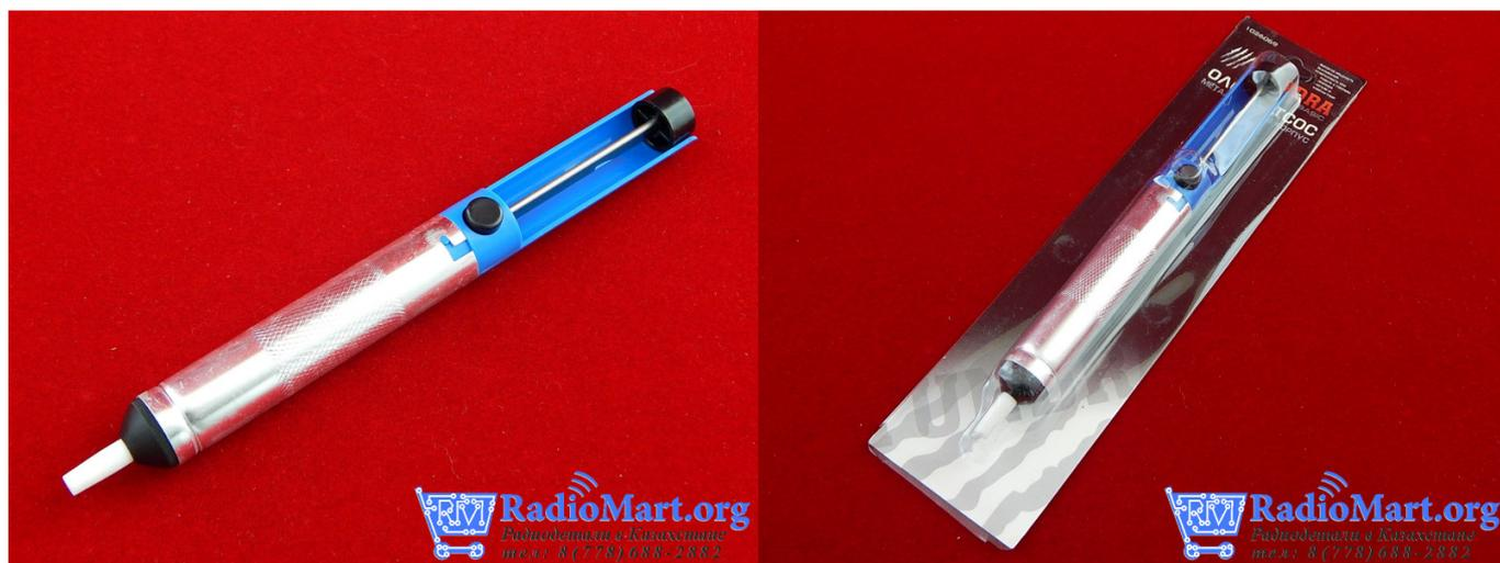
Оловоотсос "TUNDRA basic" для удаления растопленного припоя в использовании достаточно удобен, благодаря автомат-срабатыванию, при надавливании на колпак фиксатора, штока с поршнем, которые автоматически затягивают припой в шприц.
