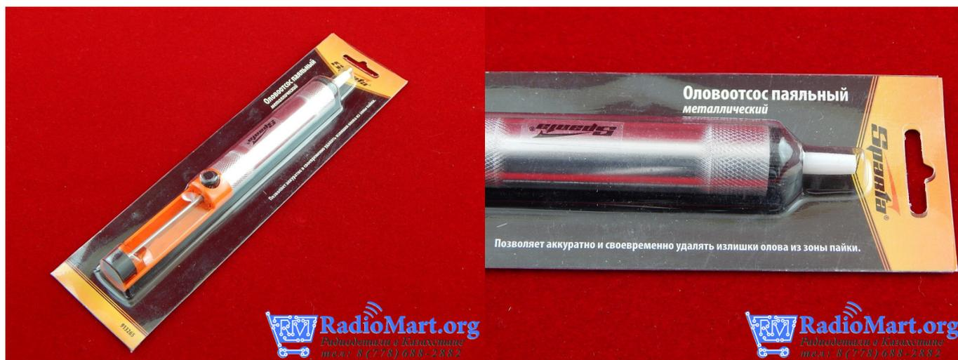
Оловоотсос "SPARTA" для удаления расплавленного припоя в использовании достаточно удобен, благодаря автомат-срабатыванию, при надавливании на колпак фиксатора, штока с поршнем, которые автоматически затягивают припой в шприц.
