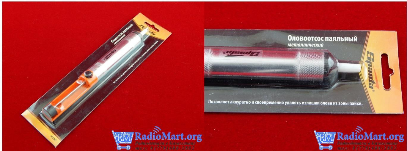
Оловоотсос "SPARTA" для удаления растопленного припоя в использовании достаточно удобен, благодаря автомат-срабатыванию, при надавливании на колпак фиксатора, штока с поршнем, которые автоматически затягивают припой в шприц.
