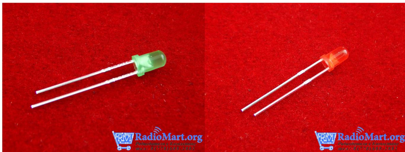
Светодиод круглый 3 мм – это полупроводниковый источник света с рабочим напряжением от 1,8В до 3,4В и силой тока в 20мА.
