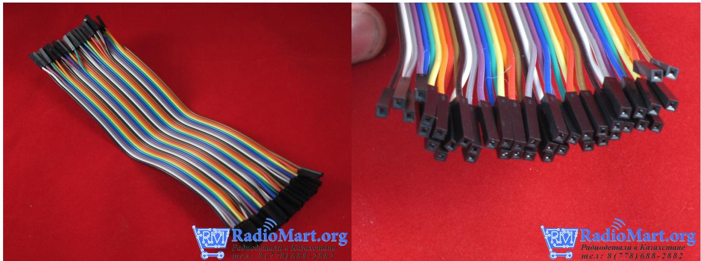
Соединительные провода мама-мама. Используются для удлинения, соединения на платах Arduino, либо как перемычка.
