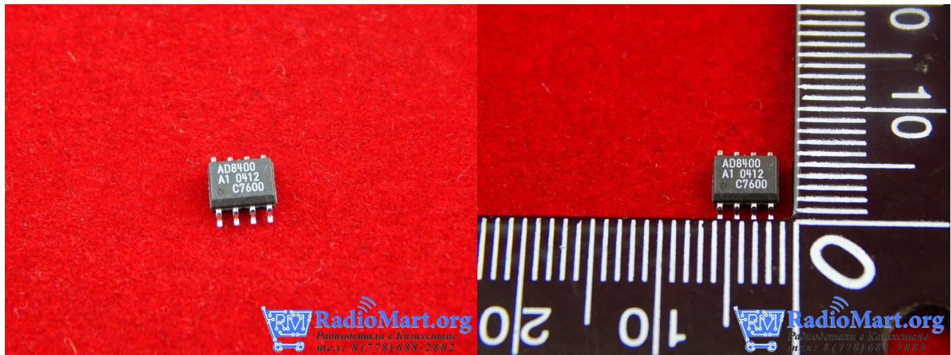
AD8400AR1 - Цифровые потенциометры позволяют осуществлять регулировку и подстройку электронных схем подобно обычным регулируемым резисторам, реостатам и механическим потенциометрам.
