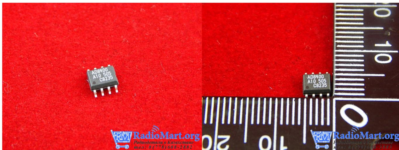
AD8400AR10 - Цифровые потенциометры позволяют осуществлять регулировку и подстройку электронных схем подобно обычным регулируемым резисторам, реостатам и механическим потенциометрам.
