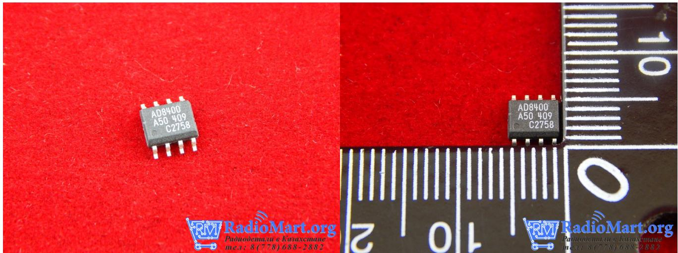
AD8400AR50 - Цифровые потенциометры позволяют осуществлять регулировку и подстройку электронных схем подобно обычным регулируемым резисторам, реостатам и механическим потенциометрам.
