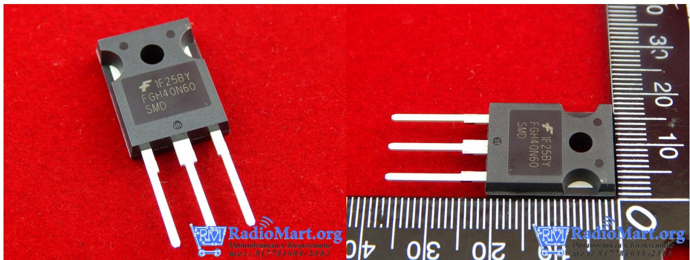
FGH40N60SMD - Биполярный транзистор с изолированным затвором (БТИЗ) (англ. IGBT от англ. Insulated-gate bipolar transistor) — трёхэлектродный силовой электронный прибор, используемый, в основном, как мощный электронный ключ в импульсных источниках питания, инверторах, в системах управления электрическими приводами.
