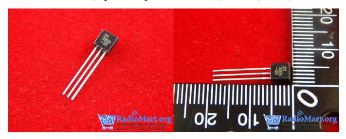
Транзистор PN2222A, 2N2222A с NPN переходом, 40B 0.6A в корпусе TO-92
