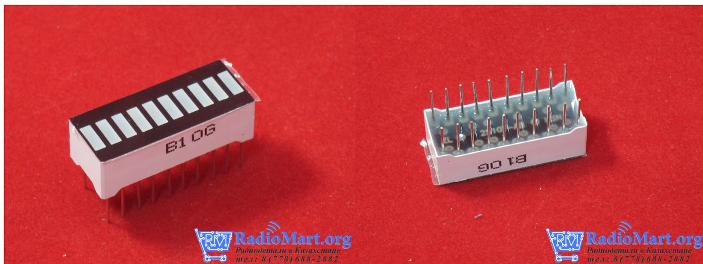
Светодиодная шкала — это 10 независимых светодиодов в одном корпусе, выложенных в форме шкалы. У индикатора 20 ножек: анод и катод для каждого светодиода. Расстояние между ножками кратно 2,54 мм, что означает возможность лёгкой установки на макетную плату.
