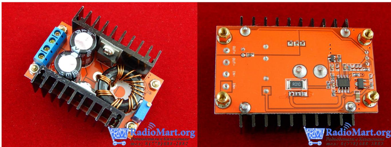
Повышающий конвертер является преобразователем постоянного тока, на базе которого можно построить портативную зарядку для ноутбука или же, подключить устройство с потреблением в 24В от 12В батареи.
