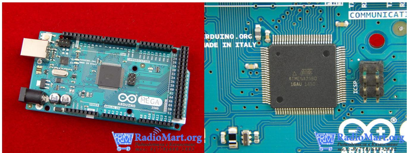
Arduino Mega 2560 — это расширенная версия Arduino Uno. Платформа выполнена на базе более продвинутого чипа ATmega2560, имеет больше контактов и большее количество аппаратных serial-портов для взаимодействия с компьютером и другими устройствами. Это самая последняя модель: Arduino Mega 2560 Rev3, пришедшая на смену предыдущим Mega 2560 и Mega 1280.
