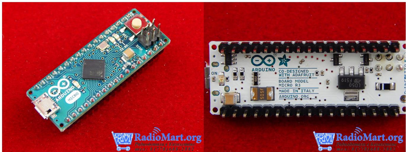
Arduino Micro — это Arduino Leonardo, выполненный на компактной плате. Отличие заключается в отсутствии собственного гнезда для внешнего питания, но оно может быть подведено непосредственно к контакту V<sub>i</sub>.
