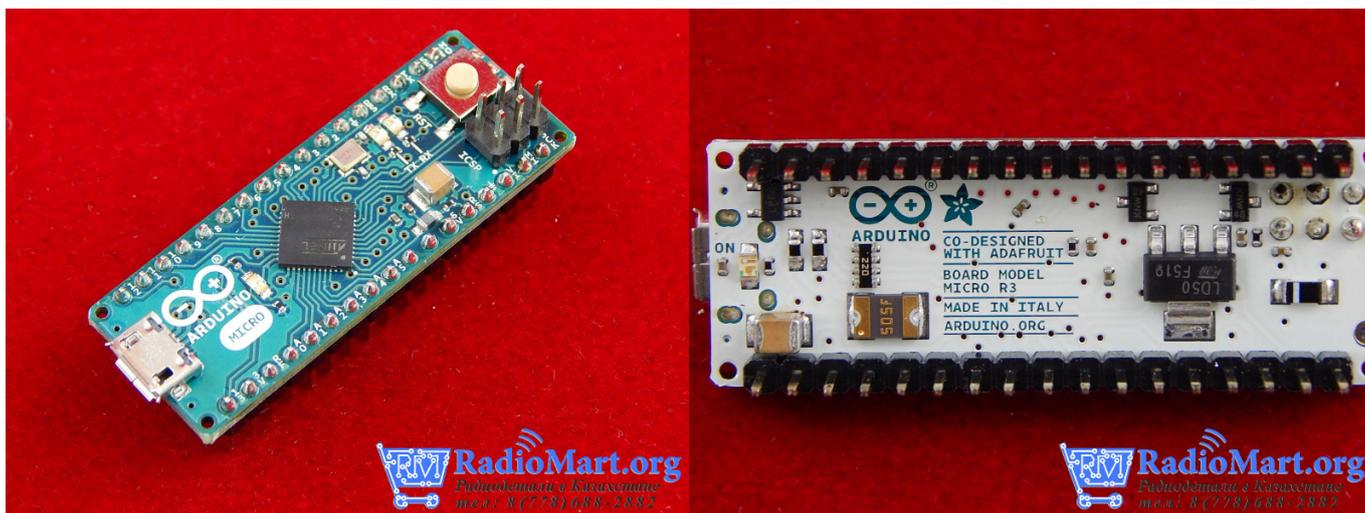
Arduino Micro — это Arduino Leonardo, исполненный на компактной плате. Отличие заключается в отсутствии собственного гнезда для внешнего питания, но оно может быть подведено непосредственно к контакту Vi.
