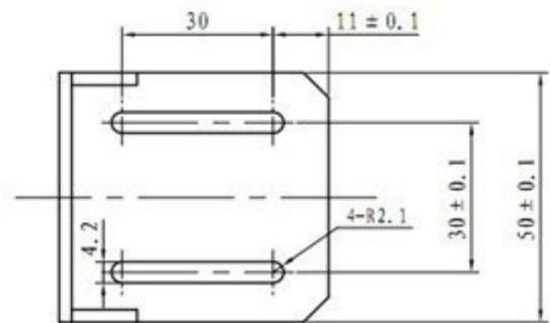
В комплекте держатель для шагового двигателя 42 серии RKP-MB42S-A с набором крепежа.
