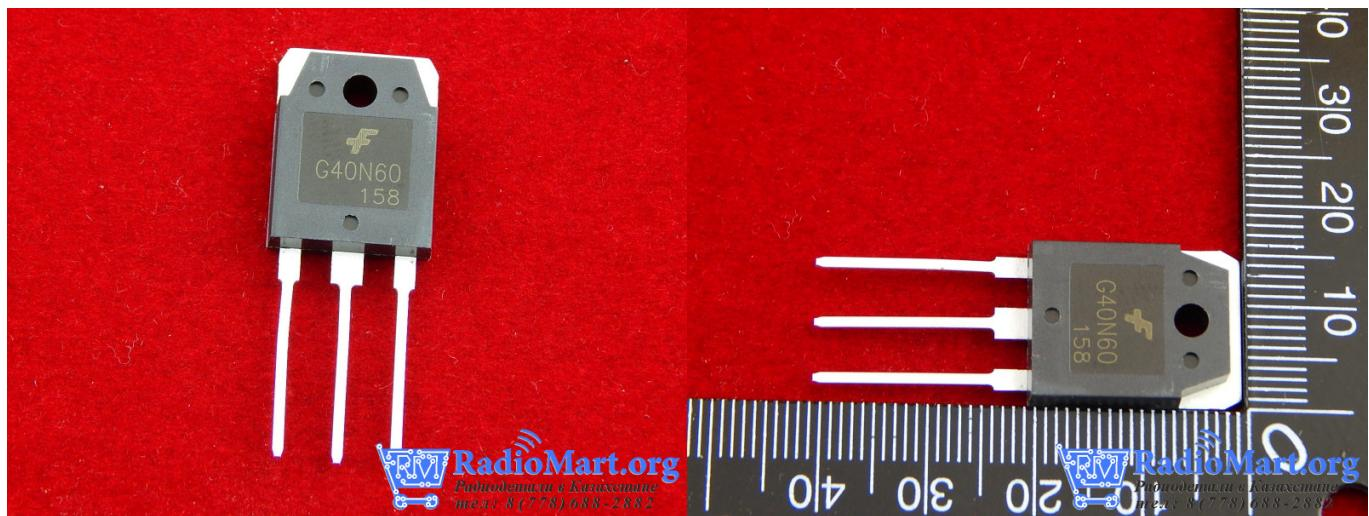
G40N60UFD, SGH40N60UFD - Биполярный транзистор с изолированным затвором (БТИЗ) (англ. IGBT от англ. Insulated-gate bipolar transistor) — трёхэлектродный силовой электронный прибор, используемый, в основном, как мощный электронный ключ в импульсных источниках питания, инверторах, в системах управления электрическими приводами.
