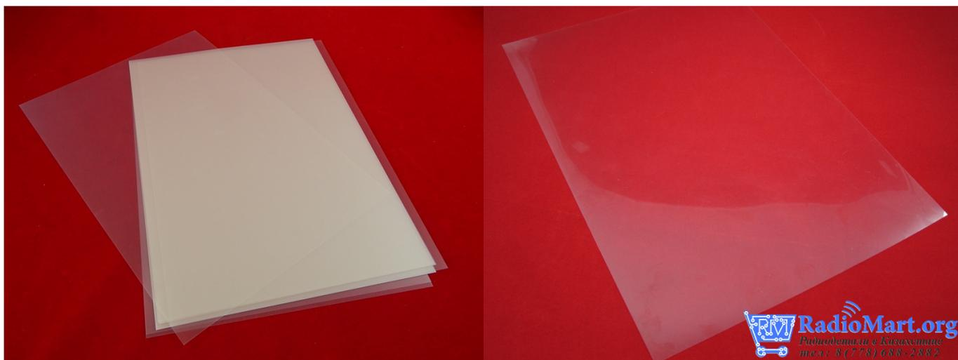
Прозрачная пленка, необходимая в производстве печатных плат для лазерного принтера, на фото не видно но она матовая светопропускающая,
