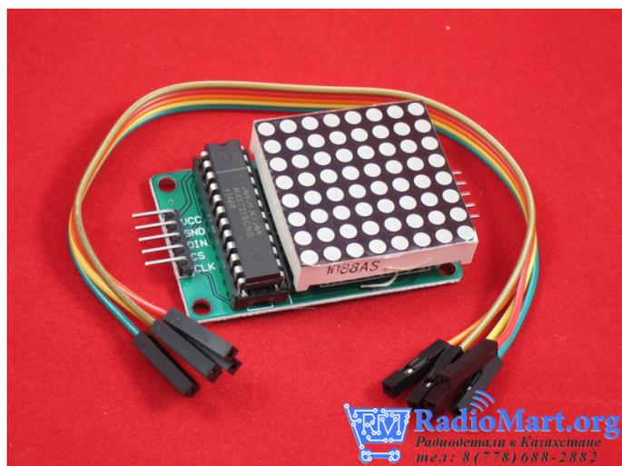
Контроллер матрицы MAX7219 подключается к Arduino через интерфейс SPI. MAX7219 представляет собой драйвера дисплея. Можно подключить несколько дисплеев одновременно на шину SPI и при условии выделения сигнала CS и независимо управлять каждым дисплеем. Левая сторона модуля имеет входной порт а правая сторона выход.
