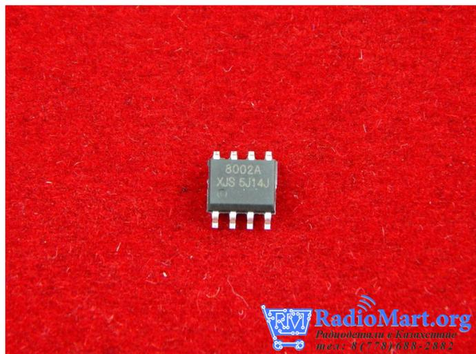
Микросхема MD8002A (маркировка 8002A), аналог NXJ8002A, MC34119, CSC8002 - усилитель 3Ч, 3W
