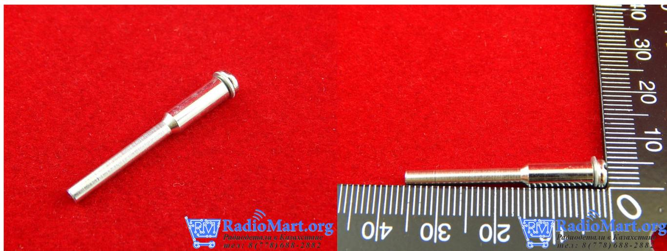
Держатель сменных дисков используется для установки и крепления насадок для обработки - отрезные круги, круги абразивные, алмазные диски с отверстием для крепления не менее 3 миллиметра и толщиной не более 6 мм. Популярен среди радиолюбителей, конструкторов и просто людей любящих делать всё своими руками.
