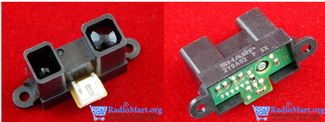
Датчик расстояния Sharp GP2Y0A02 является отличным устройством, для добавления функции обхода препятствия или обнаружения движения, вашему роботу или другому проекту. С диапазоном обнаружения от 20 до 150 см и выходным аналоговым сигналом показывающим расстояние, этот датчик очень прост в использовании.
