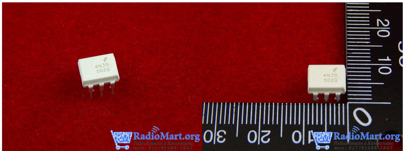
4N35, Оптопара с транзисторным выходом (AOT128A)
