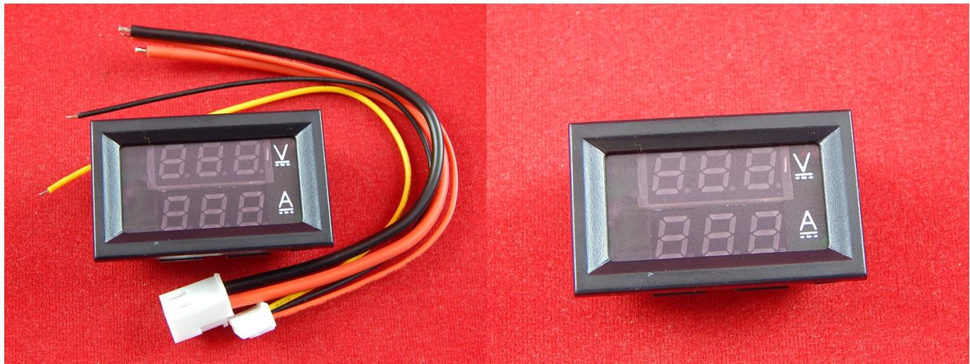
Цифровой вольтамперметр позволяет производить замеры напряжения и силы тока с выводом показателей на дисплей
