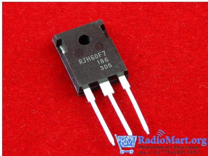
RJH60F7DPQ - Биполярный транзистор с изолированным затвором (БТИЗ) (англ. IGBT от англ. Insulated-gate bipolar transistor) — трёхэлектродный силовой электронный прибор, используемый, в основном, как мощный электронный ключ в импульсных источниках питания, инверторах, в системах управления электрическими приводами.
