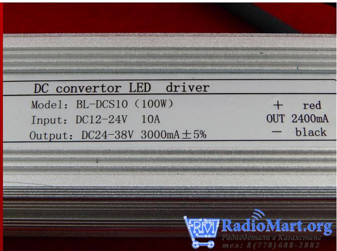
Автомобильный преобразователь напряжения с бортовых 12 вольт на 35 Вольт для подключения 100 Вт светодиодов
