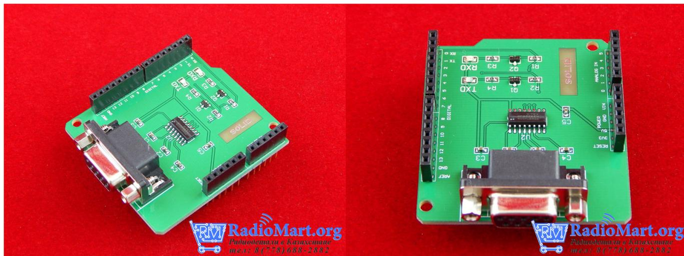
Плата расширения для Arduino, которая представляет собой стандартный порт связи для промышленного оборудования.
