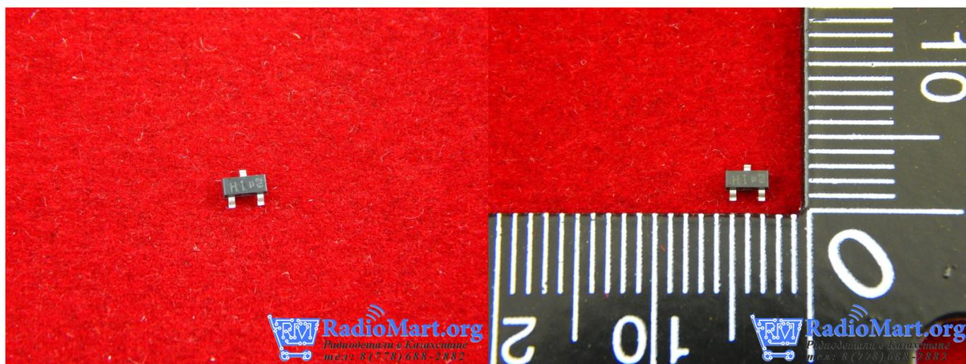
Биполярный высокочастотный pnp транзистор BCW69
