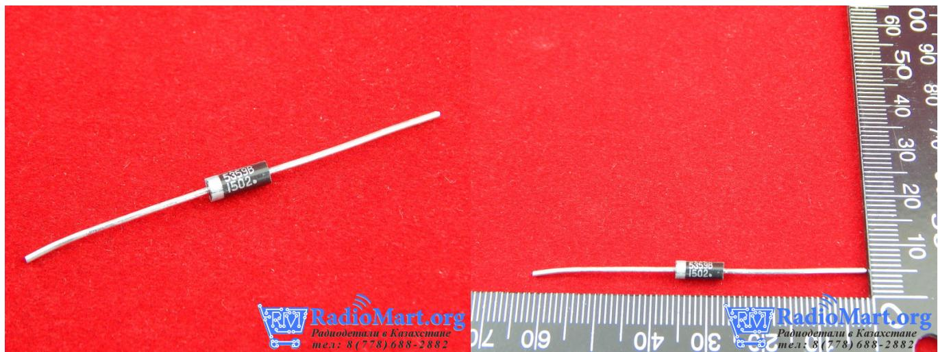
1N5359B, 24V 5% 5W DO-201 - Стабилитрон это полупроводниковый диод, предназначенный для стабилизации напряжения.
