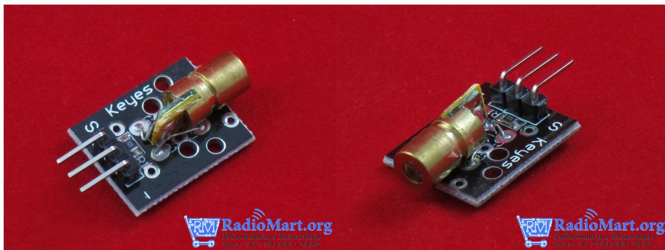
Модуль лазерного освещения для Ардуино
