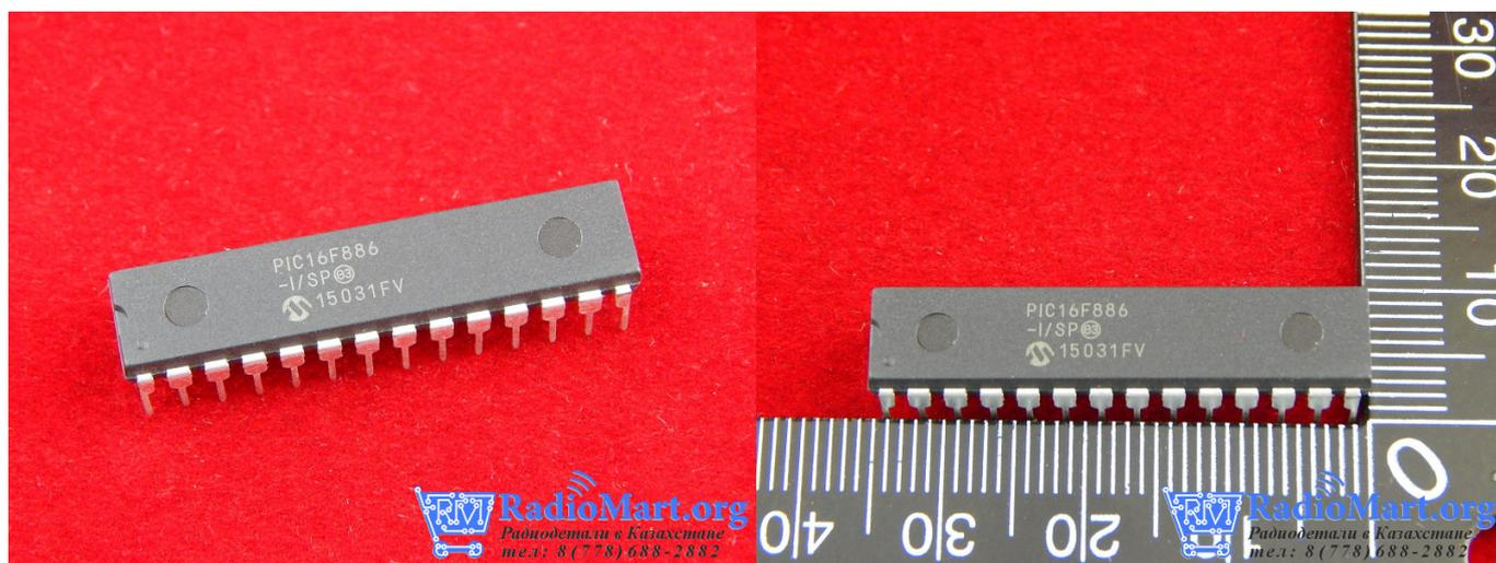
PIC16F886-I/SP - 8 битный микроконтроллер (MCU) 14 Кб Flash 368 RAM 25 I/O
