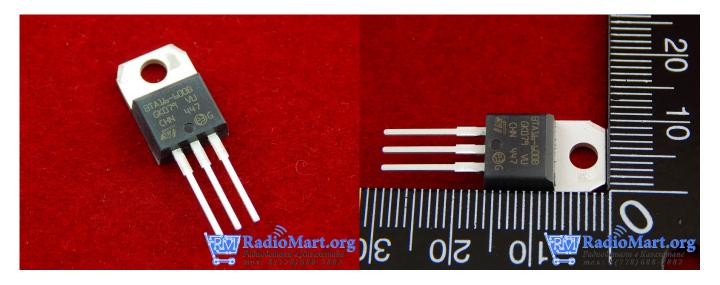
BTA16-600B - симисторы (симметричные тиристоры) средней мощности в корпусе TO-220. Фланец корпуса симистора серии BTA изолирован от остальных выводов.
