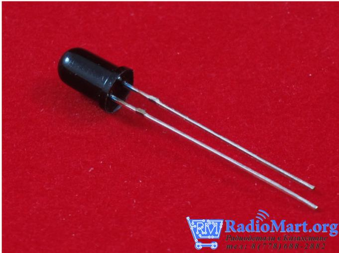
Датчик определяющий наличие пламени в радиусе действия
