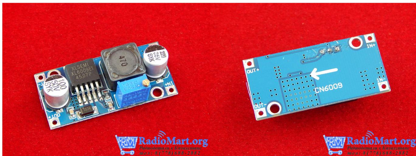
Повышающий конвертер на базе XL6009 служит для поднятия напряжения. Регулировка происходит подстроечным резистором. Удобен в проектах Arduino для подачи питания на устройства, работающих от питания выше 5V, прямо с контроллера. Либо наоборот при подаче питания к самому контроллеру Arduino с аккумулятора низкого БП.
