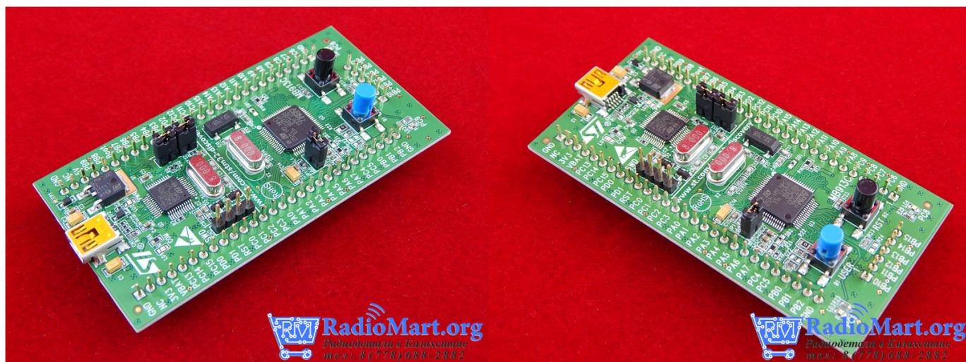
Отладочный комплект STM32VLDISCOVERY прост в использовании и является оптимальным решением не только для изучения семейства микроконтроллеров STM32F1x, но также позиционируется как встраиваемый модуль.
