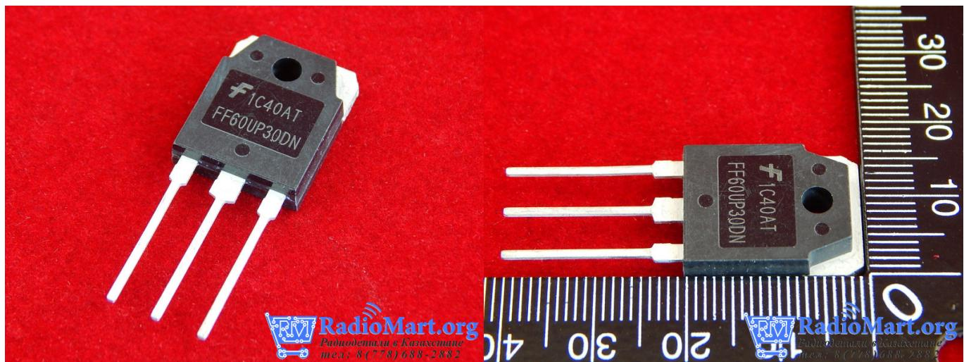
FF60UP30DN - диод быстродействующий 60A (2x30), 300V, trr = 55ns, TO-3P,
