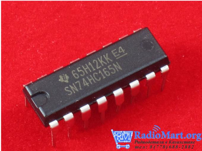
Сдвиговый регистр, преобразующий параллельный входной сигнал в последовательный выходной. Она позволяет увеличивать количество цифровых входов микроконтроллера.
