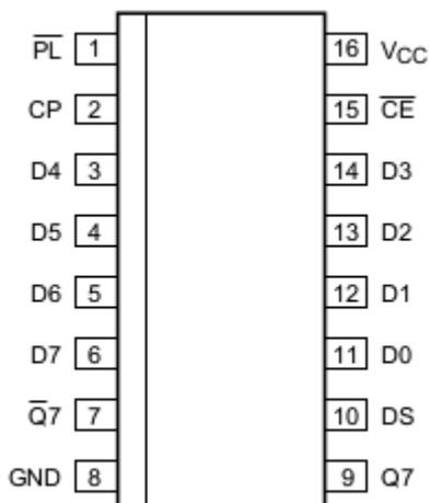
Таким образом из трёх пинов микроконтроллера, такого как Arduino, можно получить 8 цифровых входов. Из регистров 74НС165 можно делать каскады, подключая один за другим, и таким образом из всё тех же 3 входящих линий получать 16, 24, 32 и т.д. цифровых входов.
