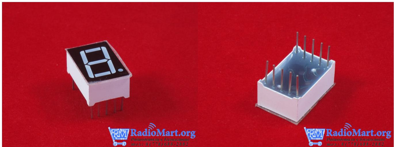
Индикатор, состоящий из семи светодиодов, установленных в форме цифры 8. Зажигая или выключая соответствующие LED-ы (сегменты) можно отображать цифры от нуля до девяти, а так же некоторые буквы.
