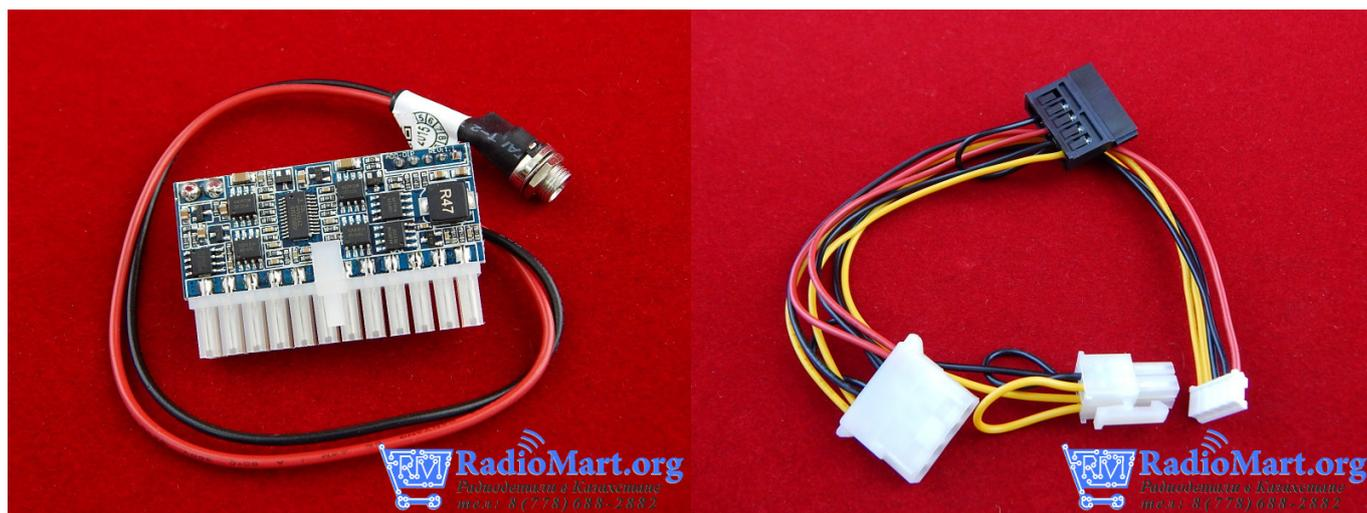
Миниатюрный блок питания модели Z3-ATX-MCU для подключения стандартной материнской платы. Часто используется для установки компьютера в автомобиле.
